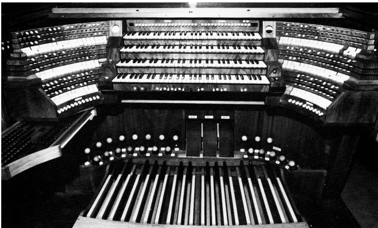
Der aktuelle Spieltisch. An seiner linken Seite erkennt man die herausgezogene Setzeranlage.
